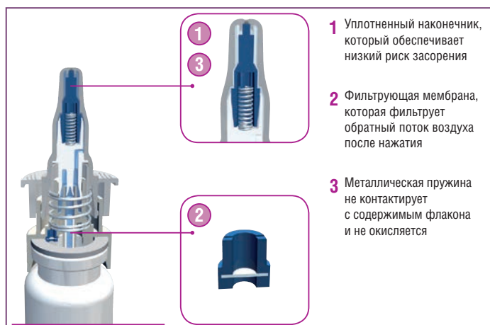
Рис. 1. Схематическое изображение дозатора назального спрея Нозефрин®
