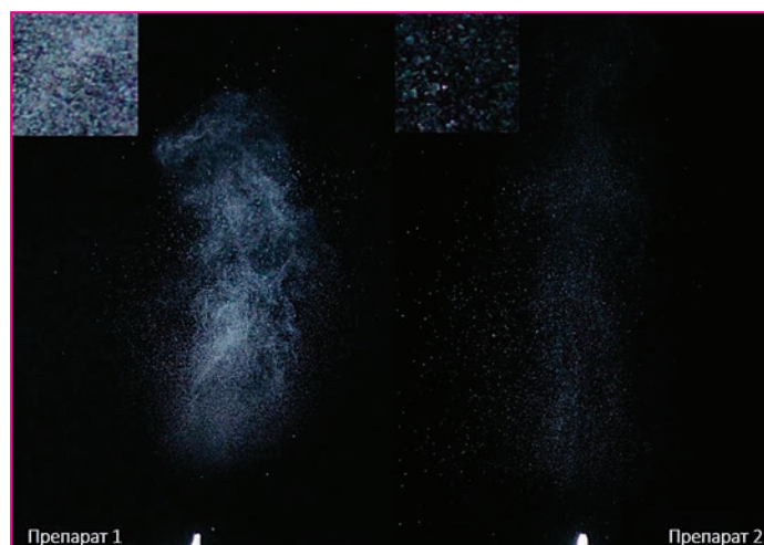
Рис. 3. Облако аэрозоля через 180–190 мс от начала распыления препаратов
