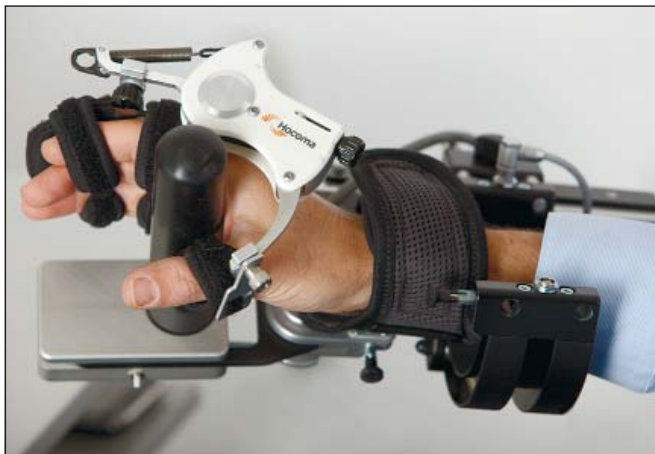
Рис. 2. Модуль Manovo Spring, Носота (Швейцария) для пассивного разгибания пальцев
