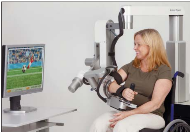
Рис. 1. Роботизированный комплекс Armeo Power, Носота (Швейцария) с биологической обратной связью
